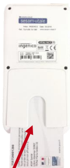
Insertion de la CPS par le bas au dos du terminal
