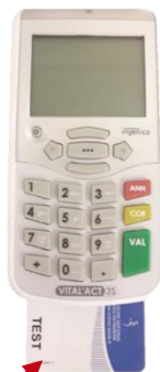
Insertion de la CPS par le bas au dos du terminal
