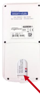
CPS insérée correctement et visible grâce à l'encoche
